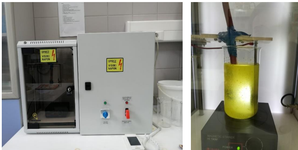
Slika 12 Uređaj za VNEP (SFE Systems Ltd., lijevo) te prikaz električnog pražnjenja u vidu izboja (desno) (Izvor: Autor)
