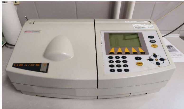
Slika 14 Spektrofotometar (Spectronic Helios Gamma UV-Vis spektrofotometar; Thermo Fisher Scientific) (Izvor: autor)
