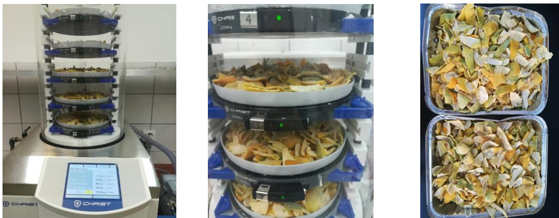
Slika 10 Prikaz postupka liofilizacije kora mandarina te uzorakanakon sušenja (Izvor: Autor)
