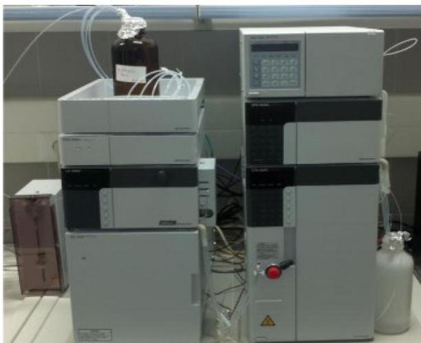
Slika 16 Shimadzu sustav za RP-HPLC
