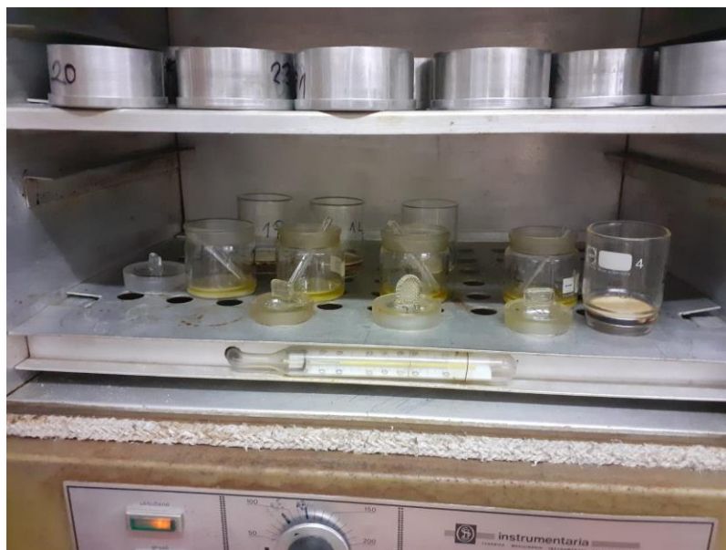
Slika 13 Sušenje netopljivog taloga na donjoj polici u sušioniku
