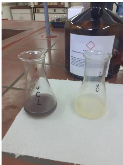
Slika 11 Određivanje peroksidnog broja
