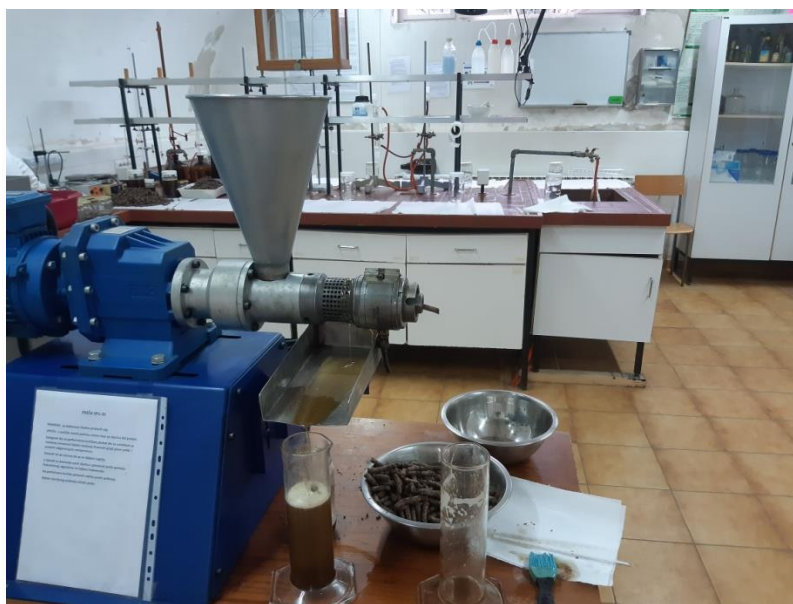
Slika 6 Prešanje sjemenki indijskog lana
