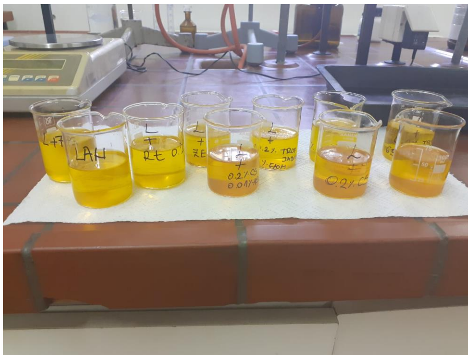
Slika 16 Uzorci nakon provođenja šest dana Oven testa
