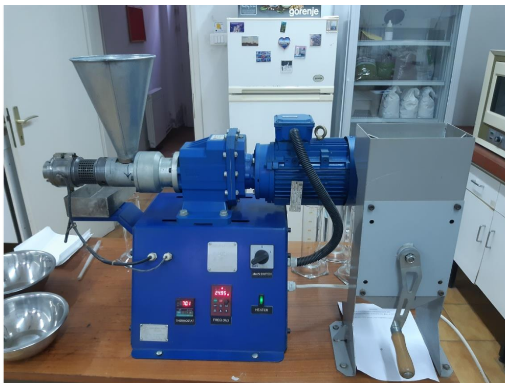
Slika 4 Laboratorijska pužna preša
