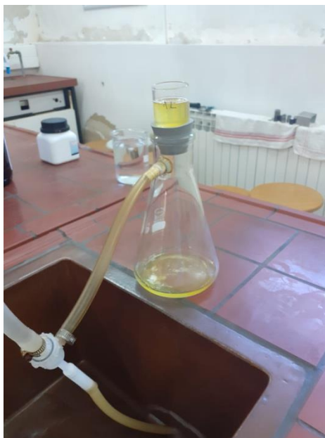
Slika 12 Vakuum filtracija organskim otapalom
