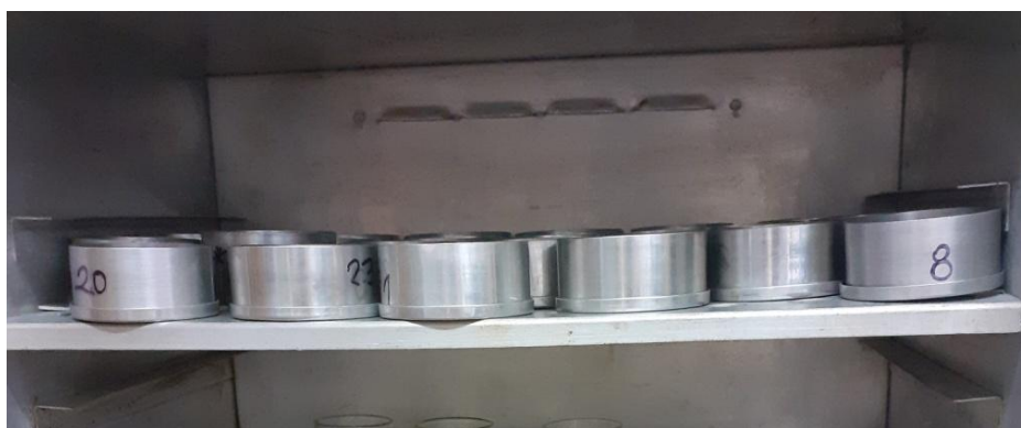
Slika 22 Određivanje udjela vlage u sjemenu i pogači
