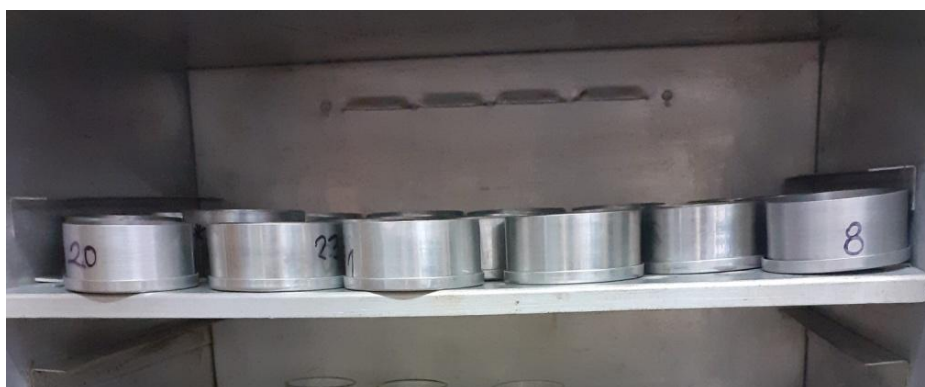
Slika 22 Određivanje udjela vlage u sjemenu i pogači
