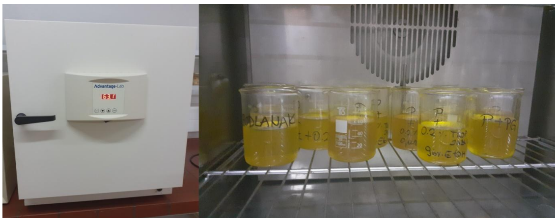
Slika 27 Provedba Oven testa na 63 °C
