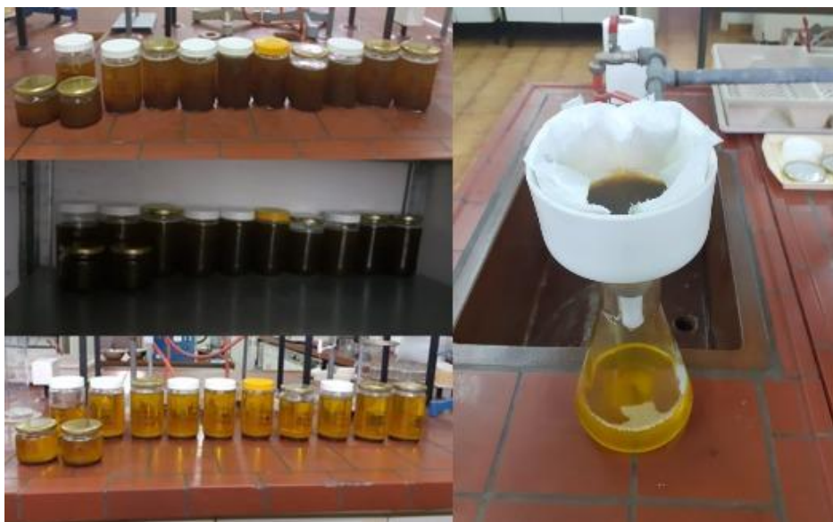
Slika 21 Lijevo - izdvajanje taloga iz zamućenog sirovog ulja, desno- vakuum filtracija
