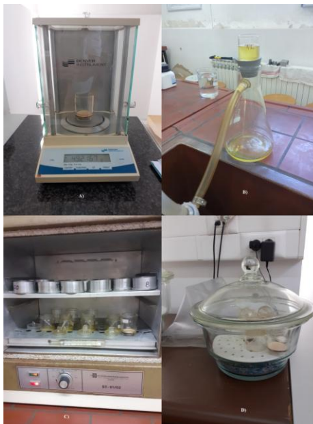
Slika 24 Određivanje netopljivih nečistoća u ulju (A- vaganje uzorka, B-filtracija, C-sušenje, D- hlađenje u eksikatoru)
