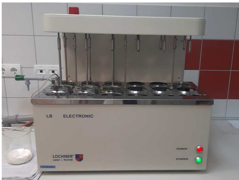
Slika 17 Uređaj za ukomljavaње Lochner® (Poljoprivredni Institut Osijek, 2020)
