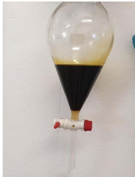
Slika 11 Razdvojene faze nakon ispiranja s NaOH
