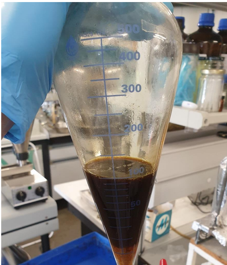
Slika 8 Acidifikacija u lijevku za odjeljivanje
