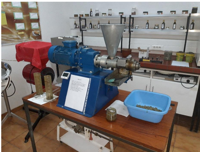
Slika 11 Kontinuirana pužna preša
