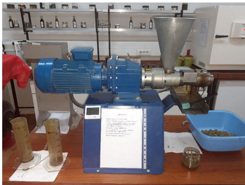
Slika 8 Kontinuirana pužna preša proizvođač ElektroMotor-Šimon d.o.o.
