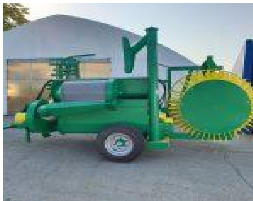
Slika 4 Kombajn za prikupljanje buče
