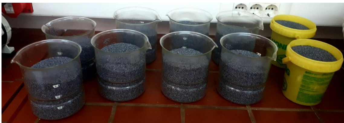
Slika 17 Sjemenke maka (5 kg) raspoređene su u posude po 0,5 kg prije prešanja
