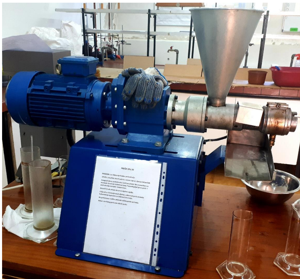
Slika 11 Laboratorijska pužna preša SPU 20
