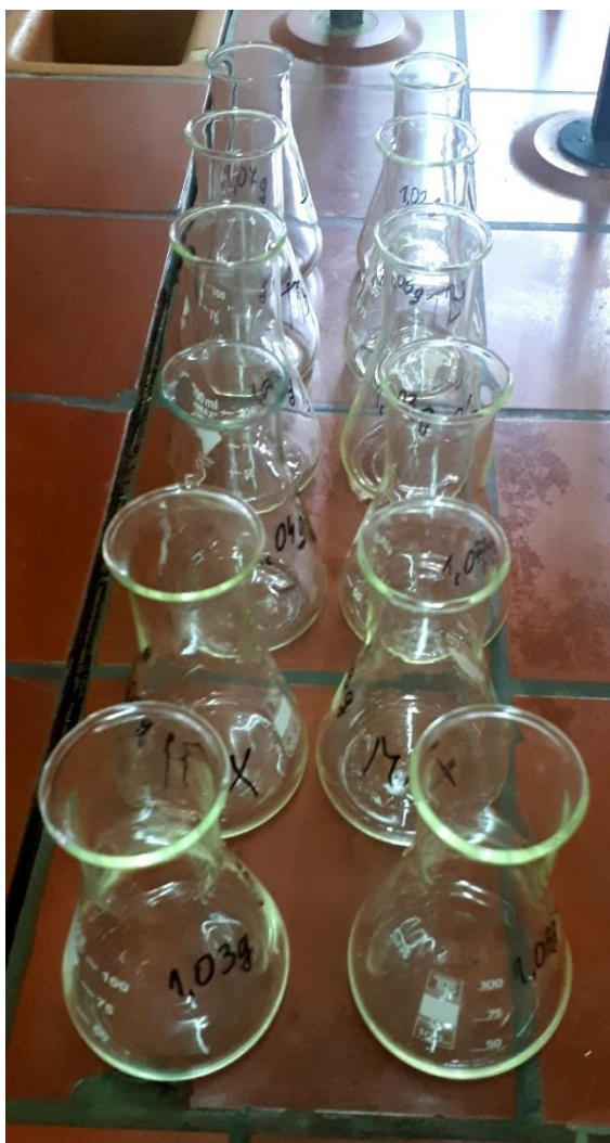
Slika 34 Priprema uzorka za analizu peroksidnog broja (Pbr) nakon zagrijavanja u sušioniku
