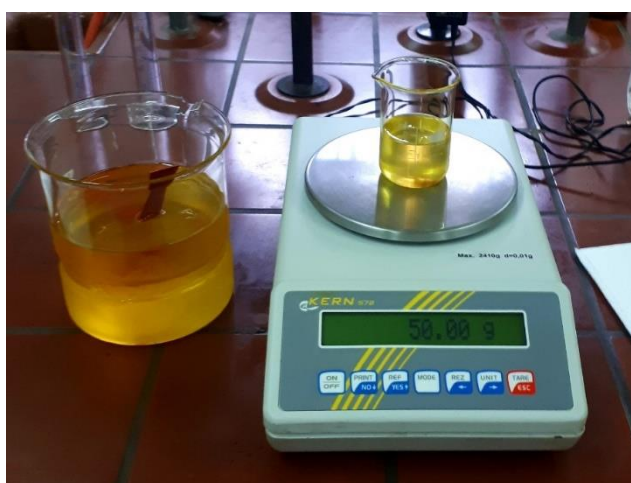
Slika 30 Priprema uzorka ulja za ispitivanje oksidacijske stabilnosti
