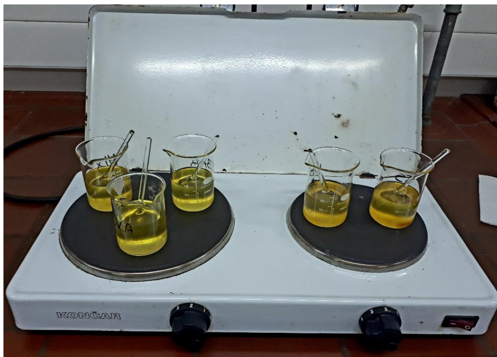
Slika 31 Zagrijavanje makovog ulja sa dodanim antioksidansima
