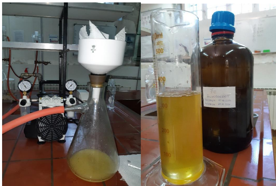
Slika 11 Vakuum filtracija sirovog ulja - lijevo, filtrirano ulje suncokreta – desno
