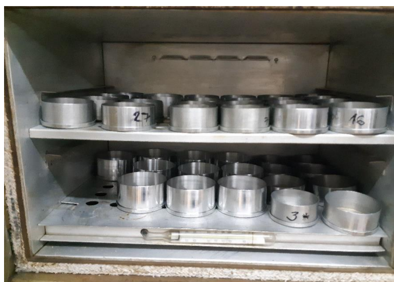
Slika 14 Određivanje udjela vlage sušenjem
