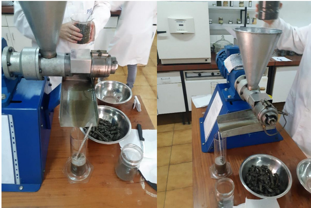
Slika 9 Hladno prešanje sjemenki suncokreta na kontinuiranoj pužnoj preši
