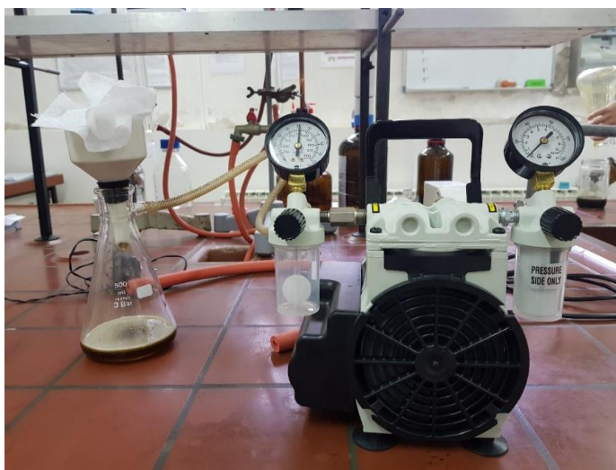
Slika 17 Vakuum filtracija sirovog ulja crnog kima
