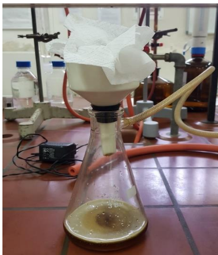
Slika 17 Vakuum filtracija sirovog ulja crnog kima
