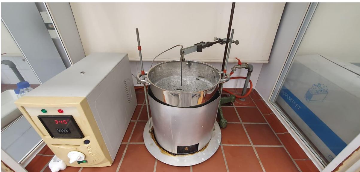
Slika 2 Aparatura za uparavanje kalcijeva klorida
