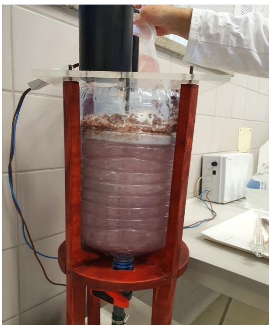
Slika 1 Šaržni reaktor za ispiranje i kiselinsku obradu ljuske jaja
