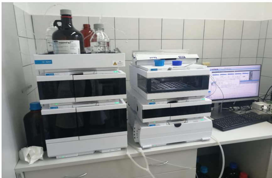
Slika 10 Visoko djelotvorni tekućinski kromatograf sa detektorom s nizom dioda (Agilent Technologies 1260 Infinity, SAD) (Izvor: autor)
