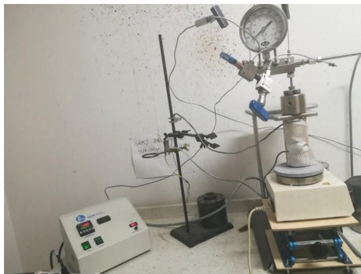
Slika 8 Uređaj za ekstrakciju s vodom u supkričnom stanju (Parr Instrument Company, USA) (Izvor: autor)
