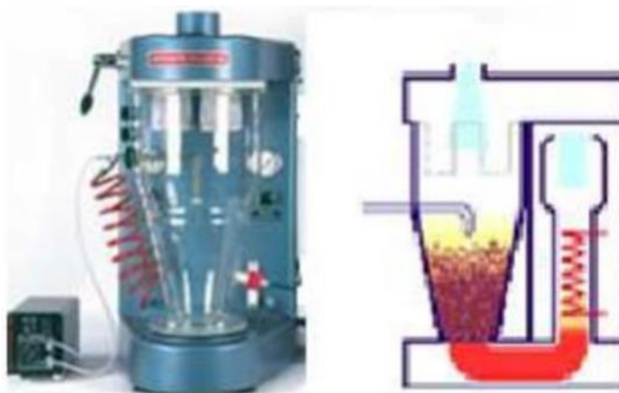
Slika 8 Uređaj za aglomeraciju i sušenje raspršivanjem (Benković i Bauman, 2011)
