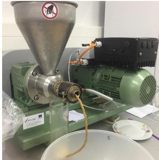
Slika 4 Laboratorijska kontinuirana pužna preša (Izvor: autor)
