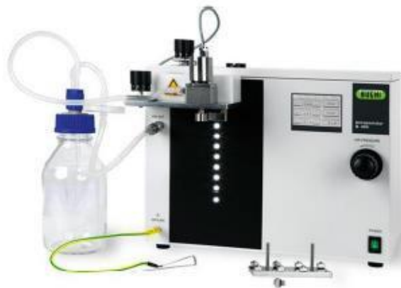
Slika 12 Enkapsulator (Büchi B-390, Švicarska)
