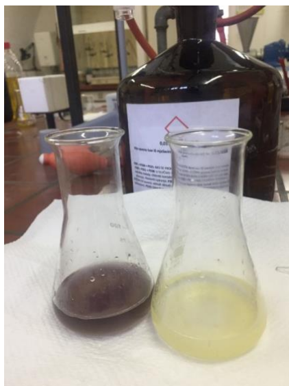
Slika 17 Određivanje Pbr (promjena boje prilikom titracije)
