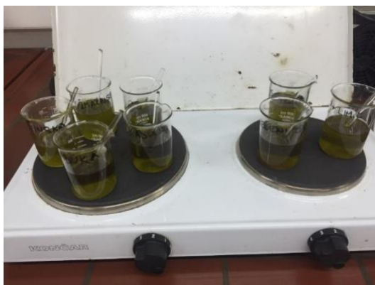
Slika 18 Zagrijavanje i miješanje kod pripreme uzorka na 70 °C
