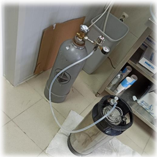
Slika 19 Gaziranje pripremljenog pića u kegu (izvor: privatna arhiva)
