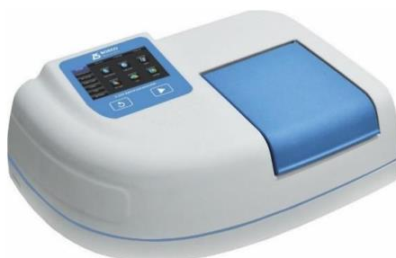
Slika 11. UV/VIS spektrofotometar, Boeco S-220 UV/VIS, Njemačka (Katalog opreme Prehrambeno-tehnološkog fakulteta 2021)
