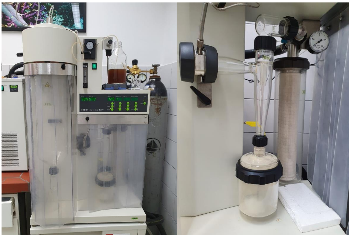
Slika 14. Uređaj Buchi Mini Spray Dryer B-290 (izvor: autor)
