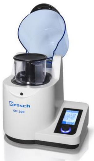
Slika 8. Mlin Grindomix GM200, Retsch GM200 (Katalog opreme Prehrambeno-tehnološkog fakulteta Osijek, 2021)
