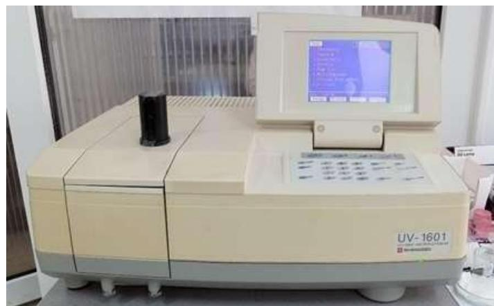
**Slika 19.** Spektrofotometar (Shimadzu UV – 1601)
