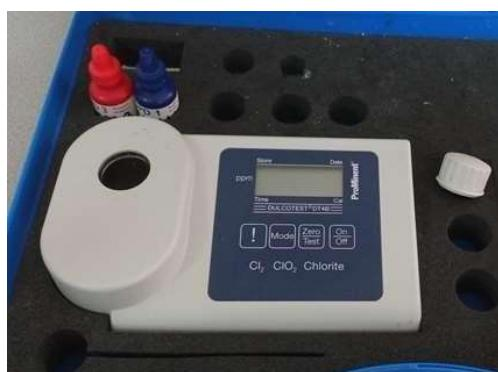
**Slika 20.** Analizator spojeva klora (Dulcotent DT4B)
