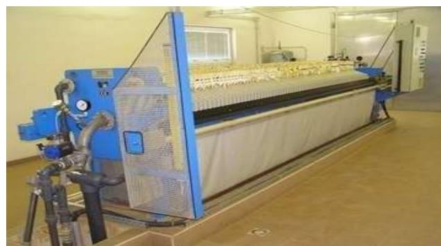
**Slika 14.** Filter preša u pogonu tvrtke Vodovod d.o.o. Slavonski Brod
