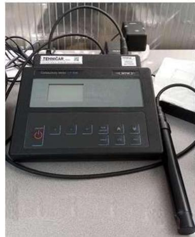
**Slika 17.** Konduktometar (Conductivity Meter LF 538)
