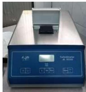
**Slika 16.** Turbidometar AL 1000 (Aqua Lytic)
