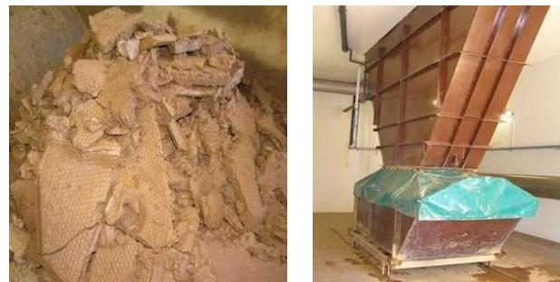
**Slika 15.** Filtarski kolač i spremnik filterskog kolača
