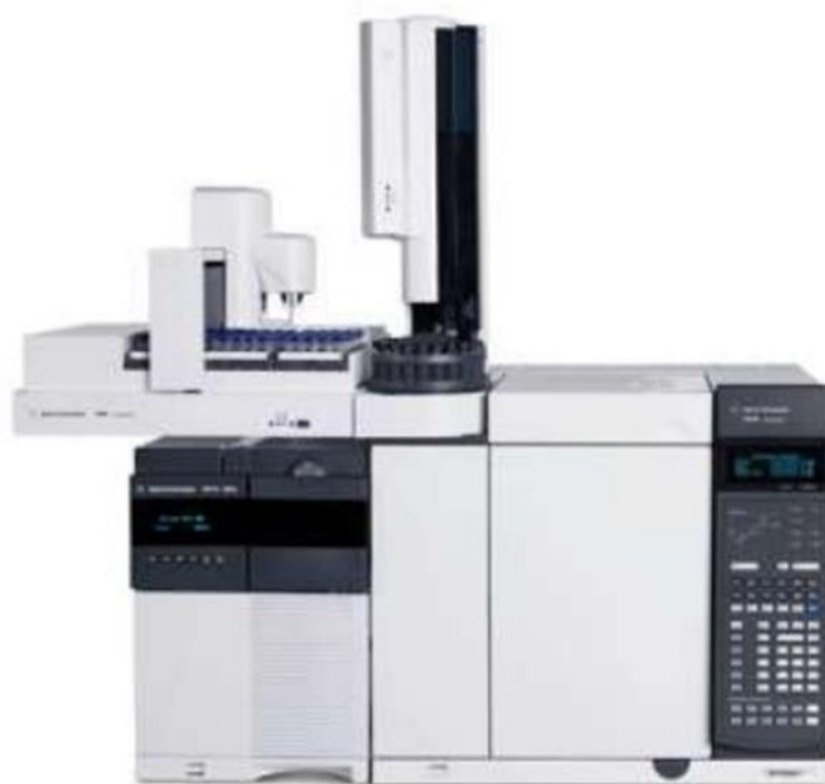
Slika 6 Plinski kromatograf u kombinaciji s masenim detektorom (Ivić, 2022)
