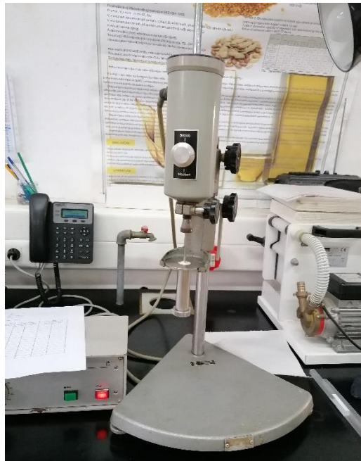
Slika 19 Rotacijski viskozimetar model „Rheomat 15 T“
