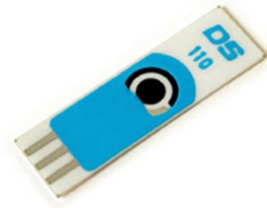
Slika 9 Komercijalna "Screen Printed" ugljikova elektroda (Web 6)
