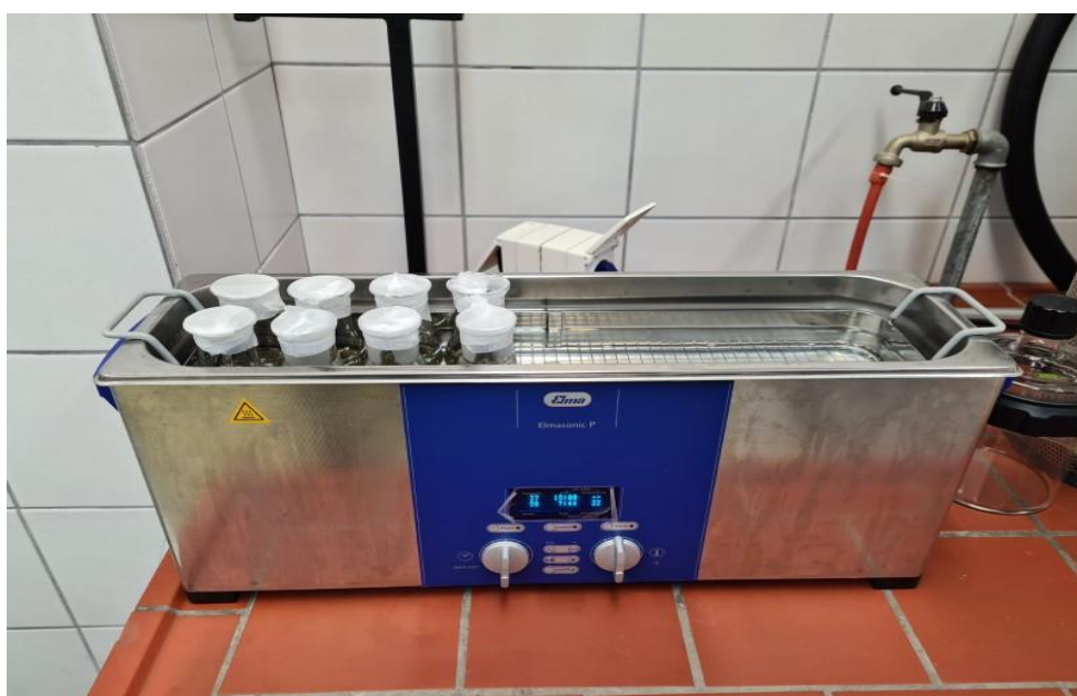
Slika 7 Ultrazvučna kupelj ELMA, Elmasonic P 120 H (Izvor: autor)
