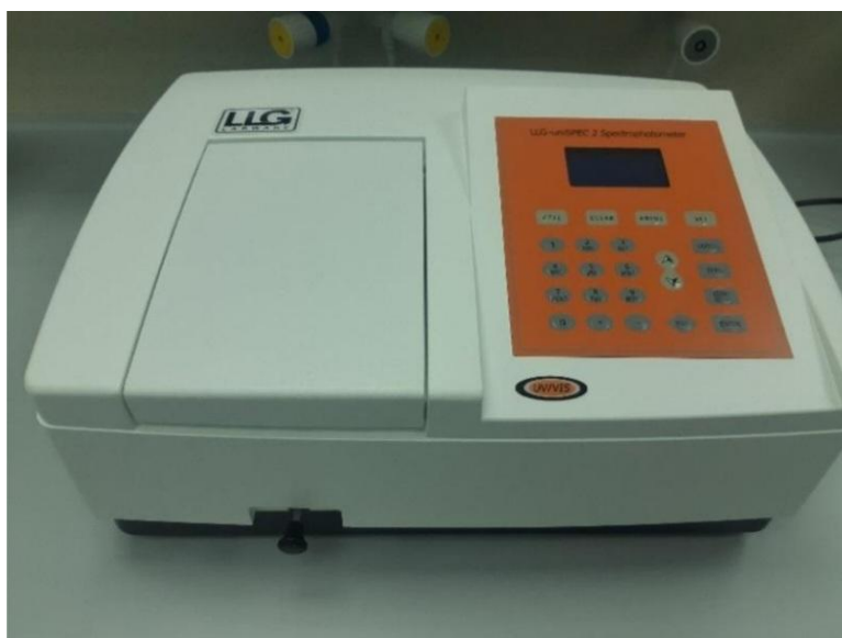
Slika 12 Spektrofotometar UV/VIS LLG Labware; Model: LLG-uniSPEC 2 (Katalog opreme Prehrambeno-tehnološkog fakulteta Osijek, 2022)
