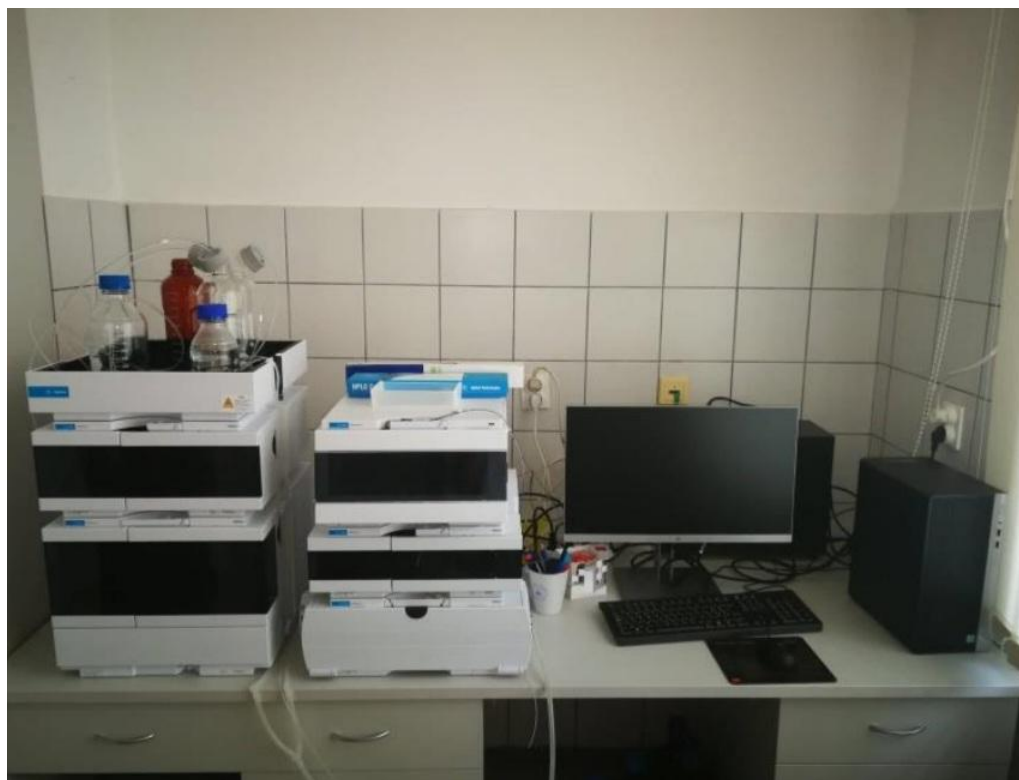
Slika 10 HPLC sustav Agilent 1260 Infinity 0 II (Katalog opreme Prehrambeno-tehnološkog fakulteta Osijek, 2022)
