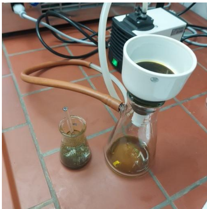
Slika 8 Sustav vakuum filtracije (Izvor: autor)
