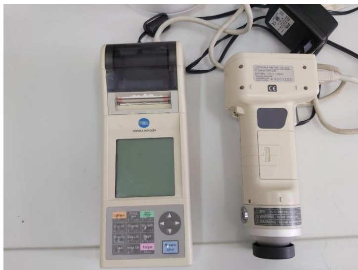
Slika 13 Kromametar Kronica Minolta CR-400
