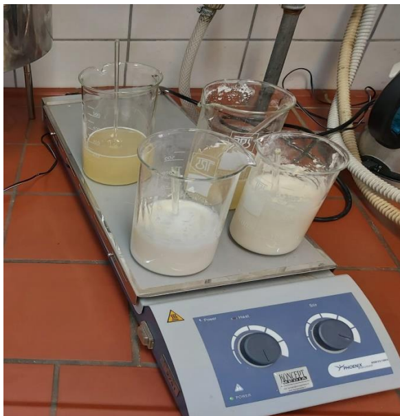
Slika 10 Miješanje uzoraka na magnetskoj mješalici
