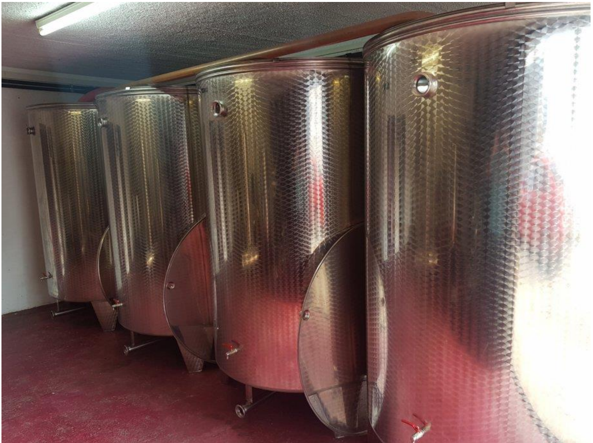
Slika 2 Tankovi za fermentaciju komine jabuke
