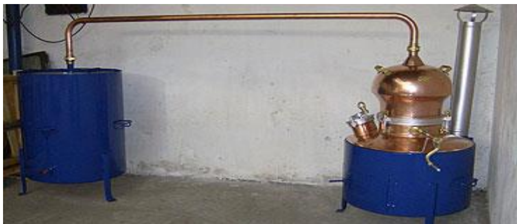
Slika 3 Tradicionalni uređaj za destilaciju, Alambik kazan
