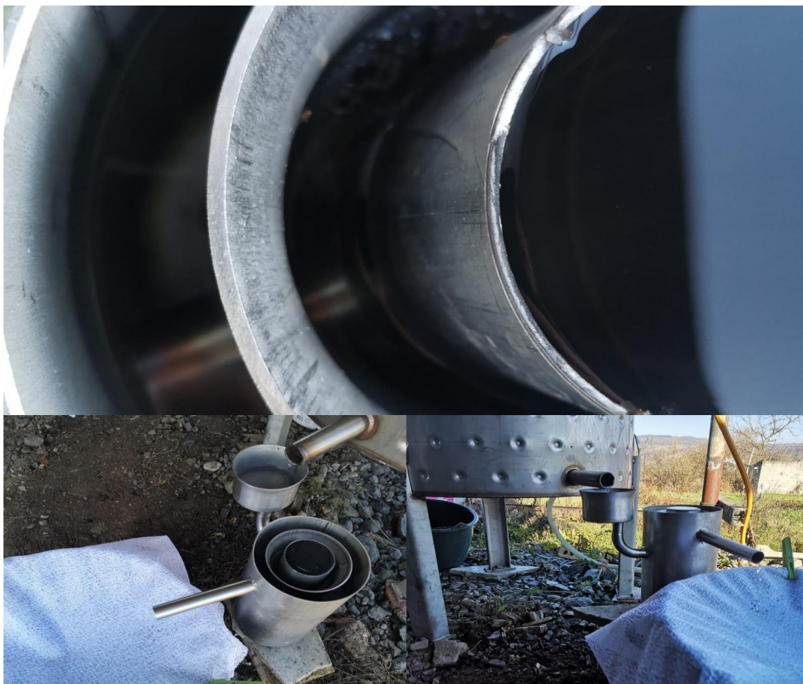
Slika 7 Instrument za dodatno izdvajanje etanola (vlastita fotografija)
