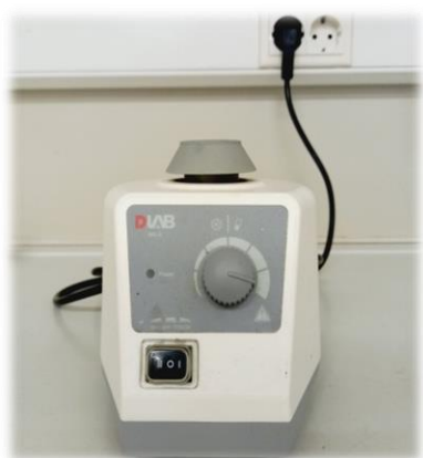
Slika 6. Mješalica, Vortex MX-S, DLAB Scientific, Kina
