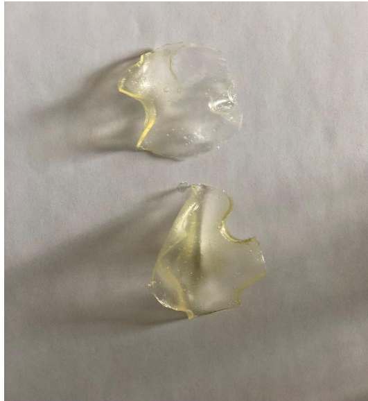
Slika 13 Biopolimerni materijal (folija) napravljen od škroba s dodanih 1,6 g plastifikatora (glicerol)
