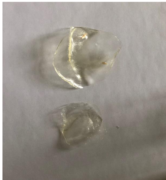
Slika 14 Biopolimerni materijal (folija) napravljen od škroba s dodanih 3 g plastifikatora (glicerol)
