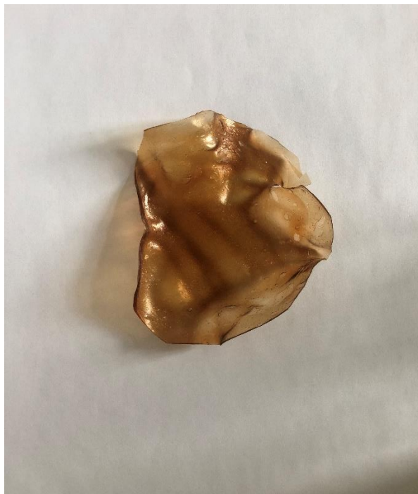
Slika 17 Biopolimerni materijal (folija) napravljen od materijala škrob-polifenoli aronije 2
