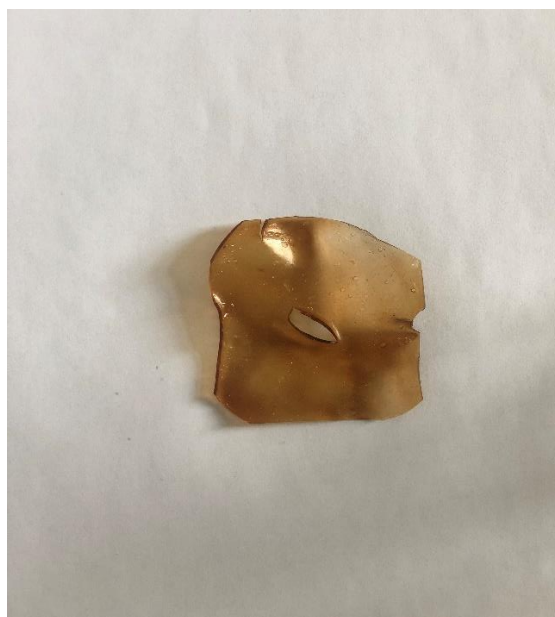
Slika 16 Biopolimerni materijal (folija) napravljen od materijala škrob-polifenoli aronije 1
