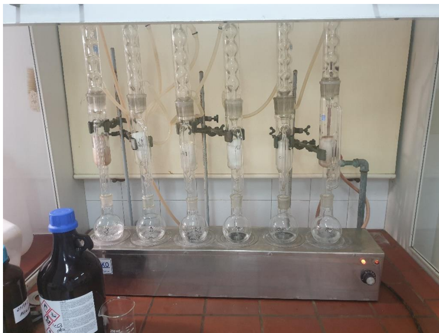
Slika 7 Metoda ekstrakcije ulja po Soxhlet-u
