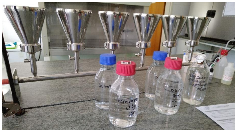
Slika 7 Uređaj za membransku filtraciju vode (Izvor: Autor)
