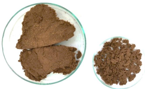
Slika 8. Otpadna inaktivna biomasa gljive G. applanatum u obliku filtracijske pogače prije mljevenja te nakon mljevenja.
