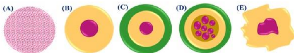
Slika 10 Morfološki prikaz mikroenkapsulata: mikrosfera (A), monosloj i mononuklearna mikrokapsula (B), multisloj i mononuklearna mikrokapsula (C), multisloj i multinuklearna mikrokapsula (D), mikročestica (E) (Mohammadalinejad i sur., 2021)
