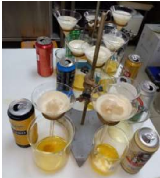
Slika 5. Filtracija uzoraka piva u laboratorijskim uvjetima (Izvor: autor).
