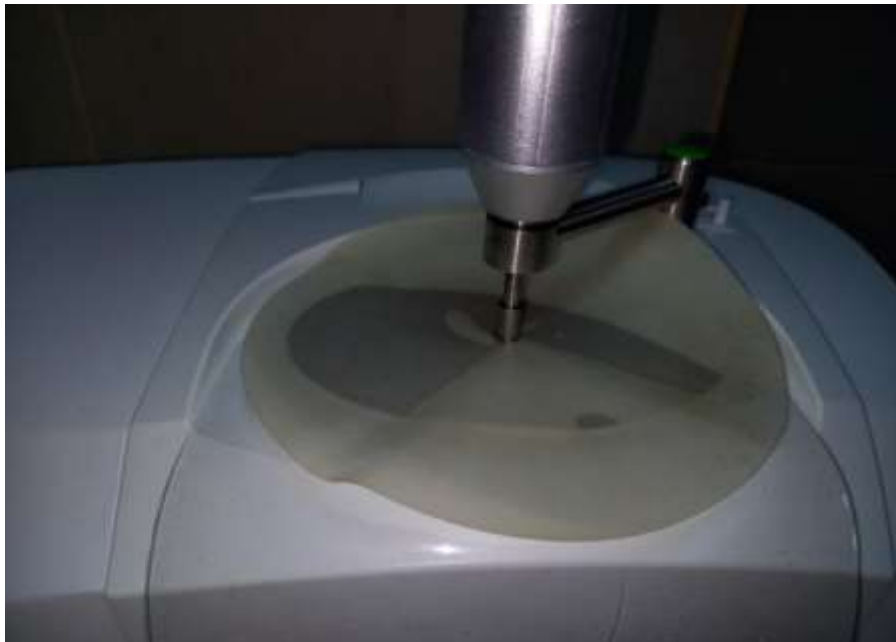
Slika 8. Osiguravanje kontakta između uzorka (natopljeni filter papir) i kristala (Izvor: autor).
