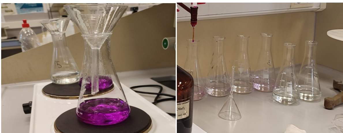
Slika 7. Vrenje uzorka s otopinom KMnO_4
