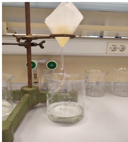
Slika 5. Filtracija vode nakon koagulacije i flokulacije
