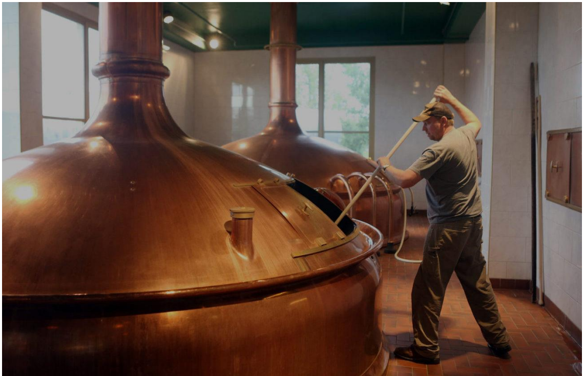
Slika 3 Ukomljavanje ili ekstrakcija slada (Web 2)
