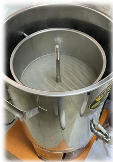
Slika 6: Postavljanje sita i mrežica u uređaj Speidel Braumeister (izvor: privatna arhiva)
