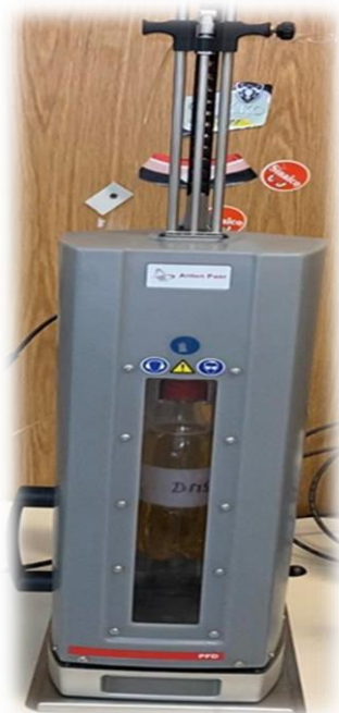
Slika 25: Uređaj Beer Analyzer tvrtke Anton Paar (izvor: privatna arhiva)
