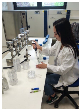
Slika 8. Nacijepijvanje uzoraka vode na mikrobiološke hranjive podloge
