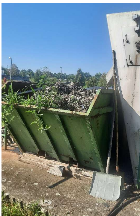
Slika 4 Otpad iz grube rešetke na UPOV Đurđevac
