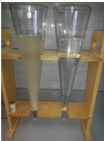
Slika 9 Mjerenje taložive tvari u Imhoffovom stošu
