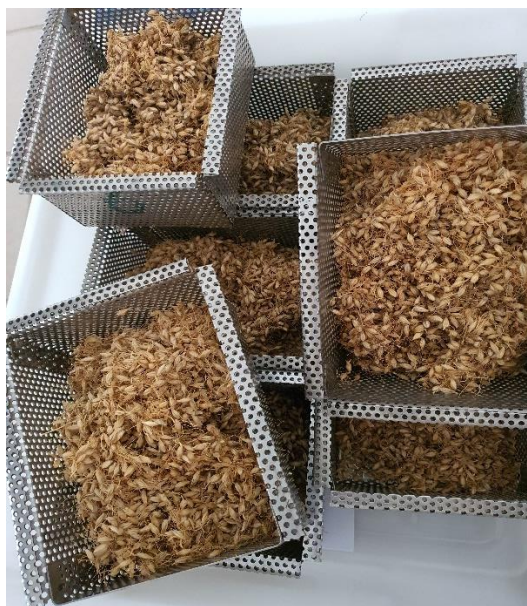
Slika 3 Slad nakon postupka sušenja
