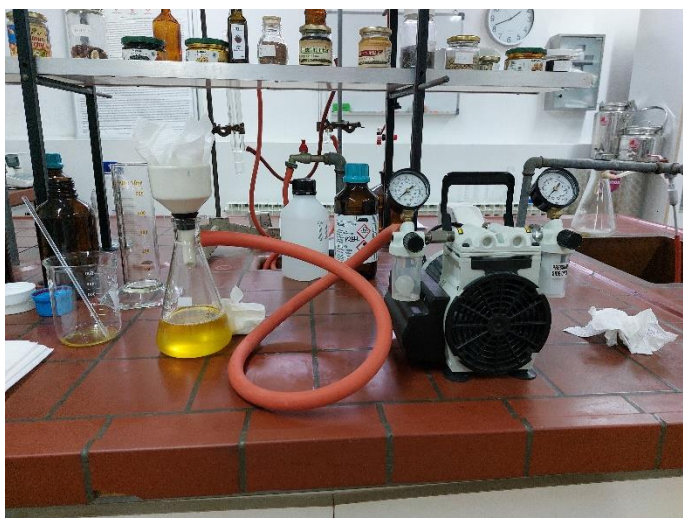
Slika 6 Dobivena pogača i sirovo ulje
