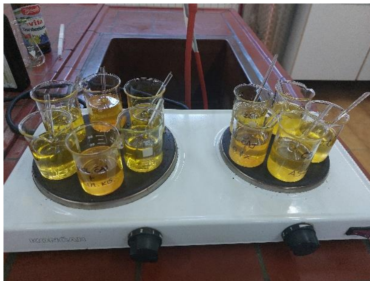
Slika 11 Zagrijavanje uzoraka kod pripreme antioksidanasa
