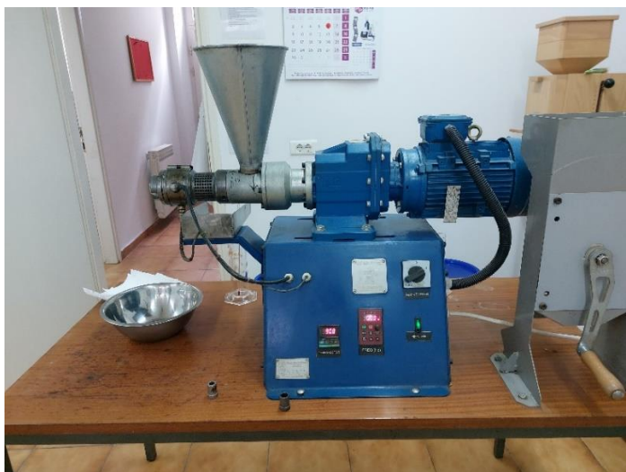
Slika 5 Kontinuirana pužna preša
