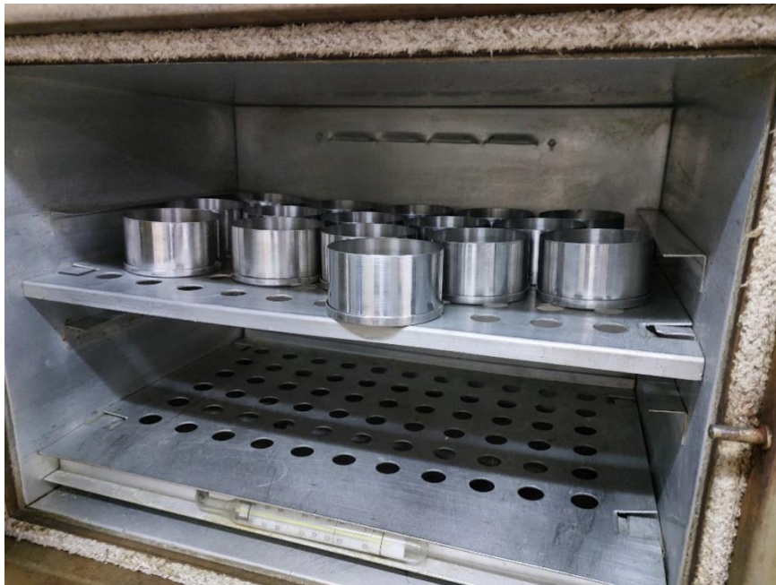
Slika 9 Posudice s uzorcima u sušioniku
