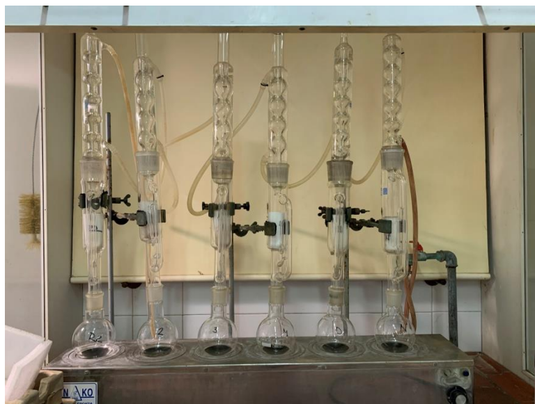
Slika 21 Ekstrakcija ulja po Soxhletu
