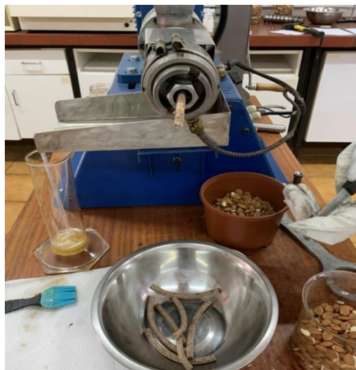
Slika 10 Izlaz pogače tijekom prešanja
