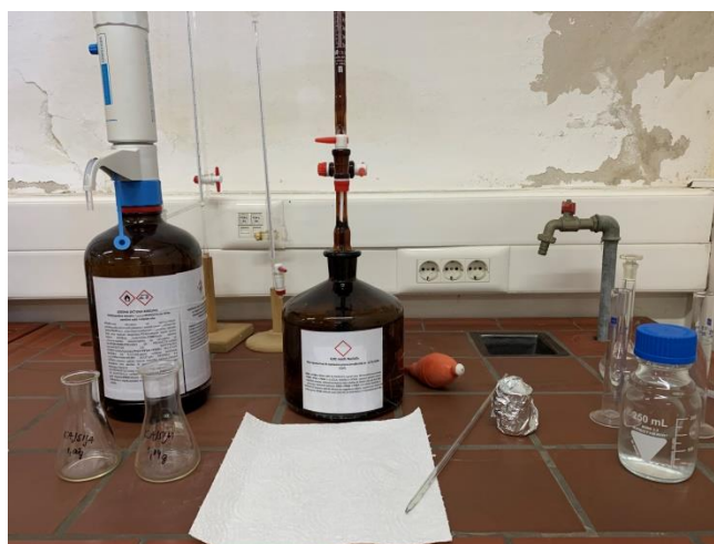
Slika 22 Određivanje peroksidnog broja u ulju
