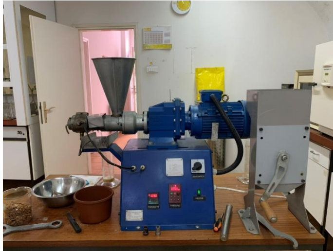
Slika 9 Pužna preša za proizvodnju ulja koštice marelice
