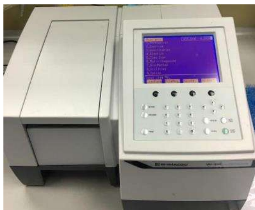
Slika 11. Spektrofotometar (UV-1280, UV-VIS Spectrophotometer, Shimadzu, Japan)
