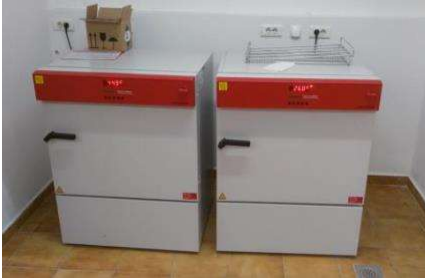
Slika 8. Laboratorijski inkubator (BINDER GmbH, KB 115, Njemačka)
