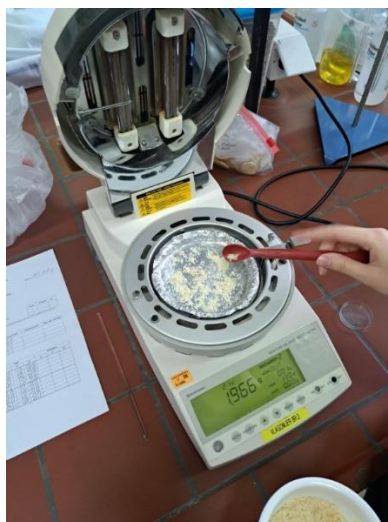
Slika 7 Određivanje sadržaja vlage halogenim analizatorom vlage
