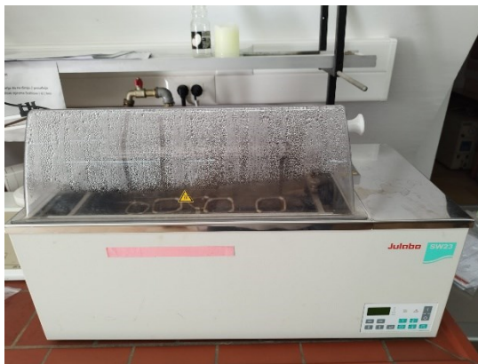
Slika 7. Vodena kupelj Julabo SW-23 (Julabo, Njemačka)
