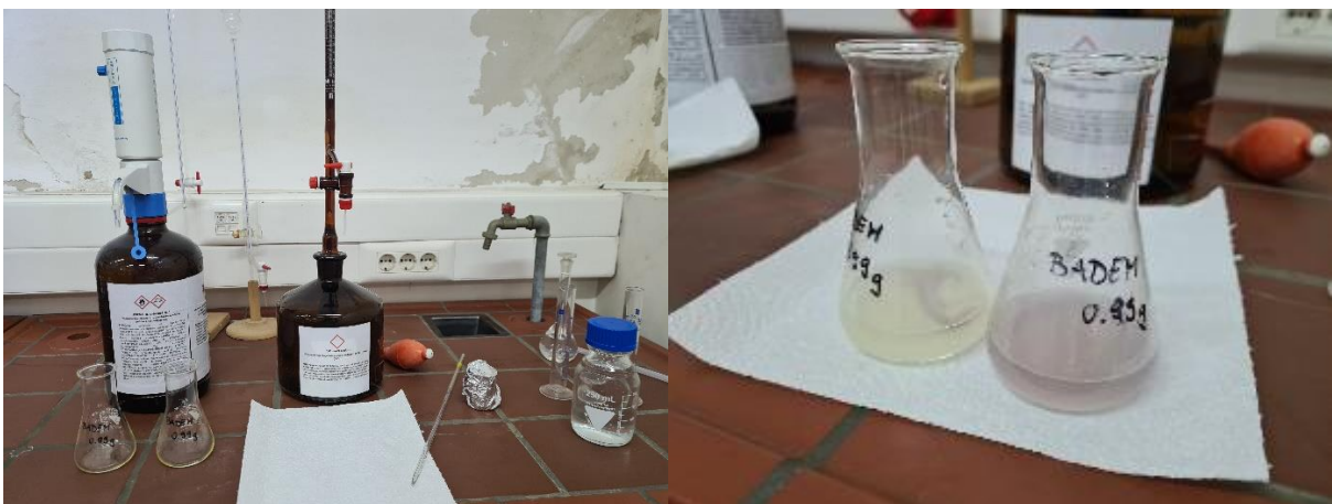
Slika 21 Određivanje peroksidnog broja u ulju (po Wheeleru)
