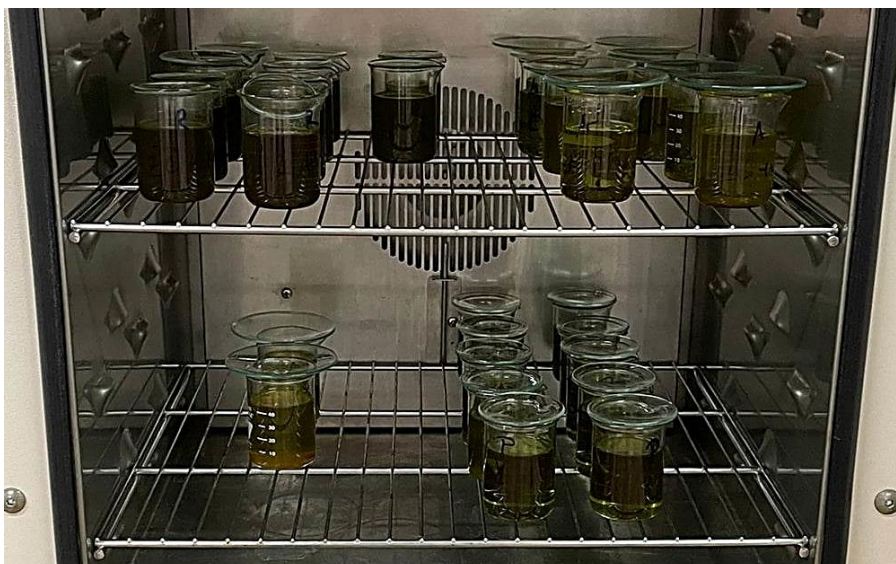
Slika 9 Pripremljeni uzorci u sušioniku za određivanje oksidacijske stabilnosti (Izvor: autor)
