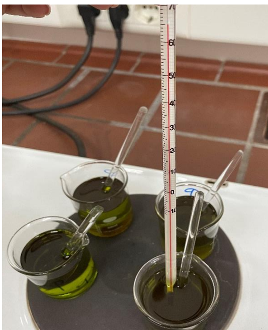
Slika 15 Zagrijavanje uzorka uz miješanje (Izvor: autor)
