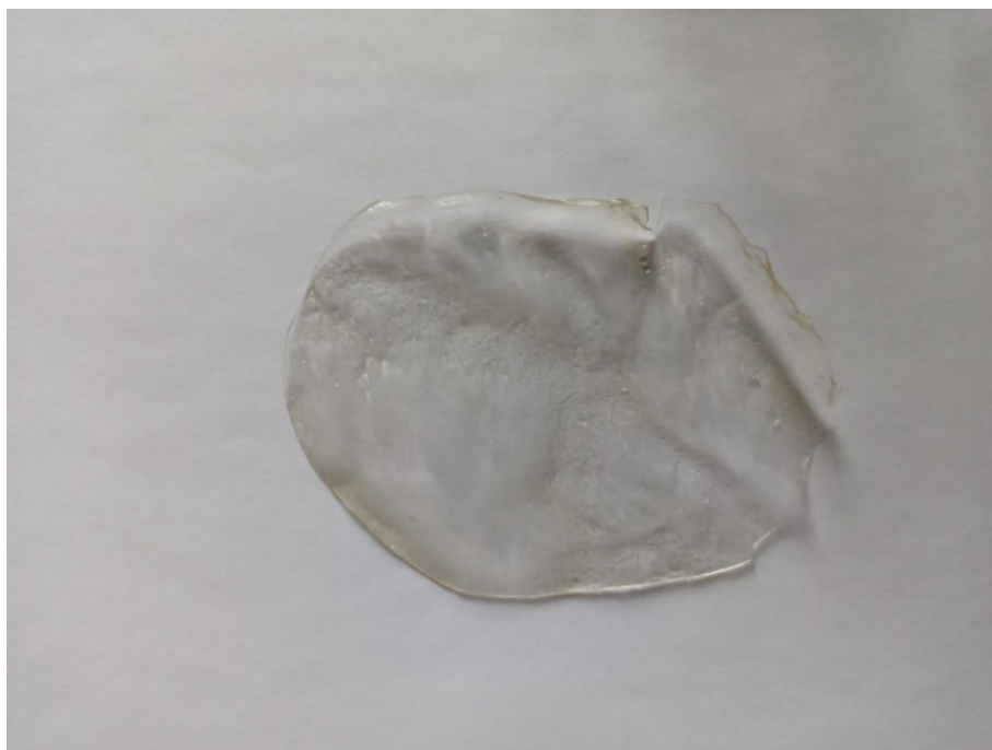
Slika 29 Biopolimerni materijal napravljen od materijala škrob-polifenoli mesa jabuke 1
