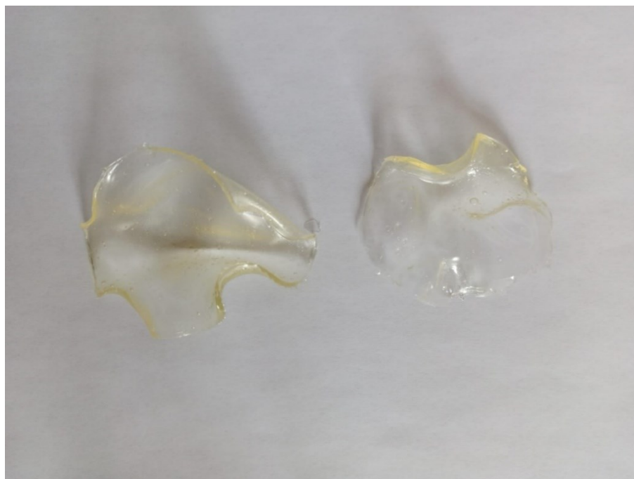
Slika 26 Biopolimerni materijal napravljen od škroba s dodanih 1,6 g plastifikatora (glicerol)
