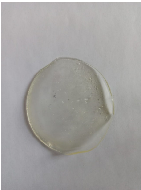
Slika 28 Biopolimerni materijal napravljen od škroba s dodanih 5 g plastifikatora (glicerol)
