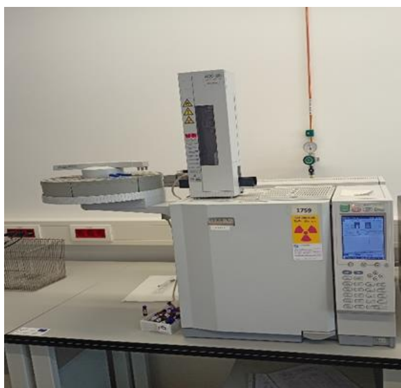
Slika 2 Plinski kromatograf Shimadzu GC2010+ s detektorom zahvata elektrona koji je korišten u analizi uzoraka
