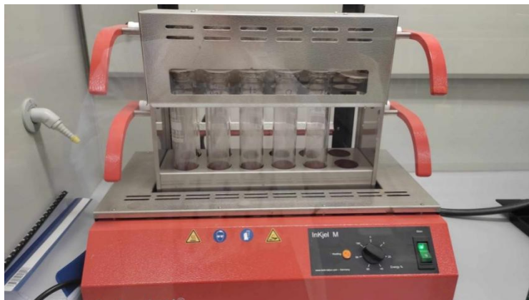
Slika 18 InKjel M jedinica za spaljivanje – razaranje uzorka makroalgi (Potočar, 2023)
