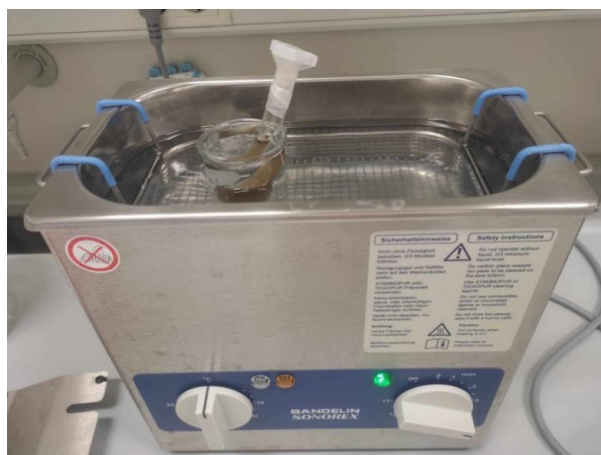
Slika 22 Ekstrakcija na ultrazvučnoj kupelji (Potočar, 2023)
